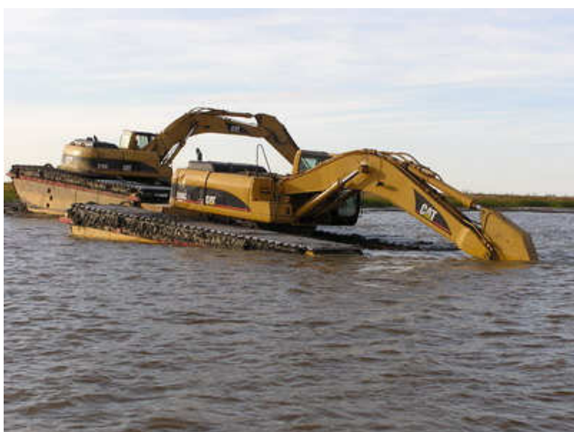
Плаващ екскаватор на база CAT 330CL
