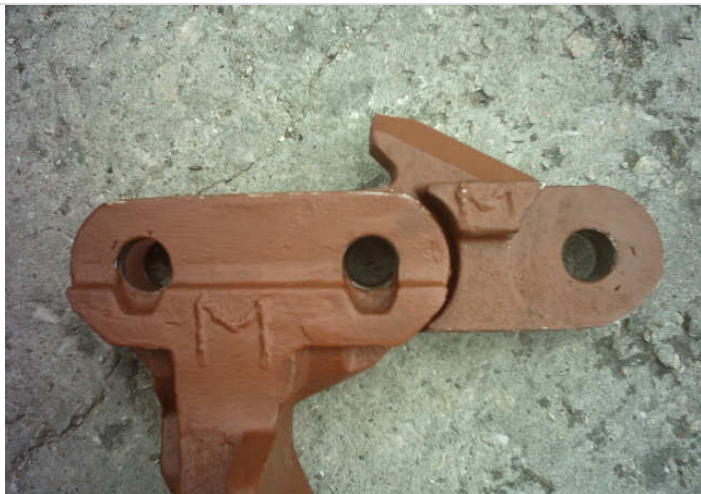
Фиг.3 Пресевна Plasser - Възстановени отвори на звена и зъби на верига – технология II / ПЕПЖИ гр.Плевен /.
