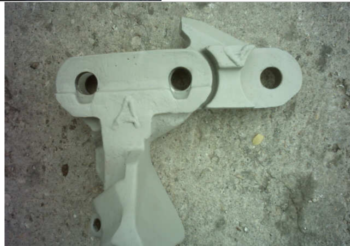
Фиг.2 Пресевна Plasser - Възстановени отвори на звена и зъби на верига – технология I / ПЕПЖИ гр.Плевен /.
